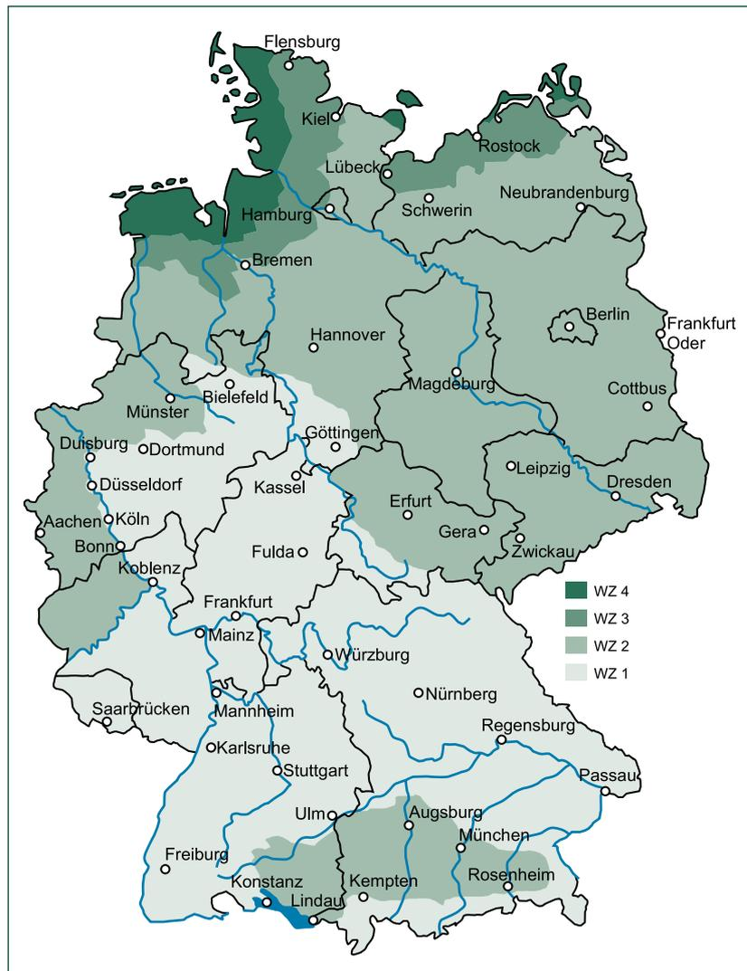
Bild 4: Einstufung in Windzonen gemäß DIN 1055 Teil 4
