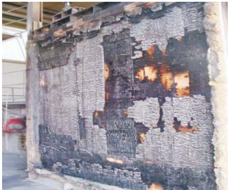
Brandversuch mit der Massiv-Holz-Mauer®: Eine MHM-Wand, 20,5cm dick und einseitig mit Gipskartonplatten 18mm beplankt erreicht REI 90.
