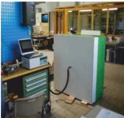
Luftdichtigkeitsmessung eines MHM-Elements an der FH Kempten
