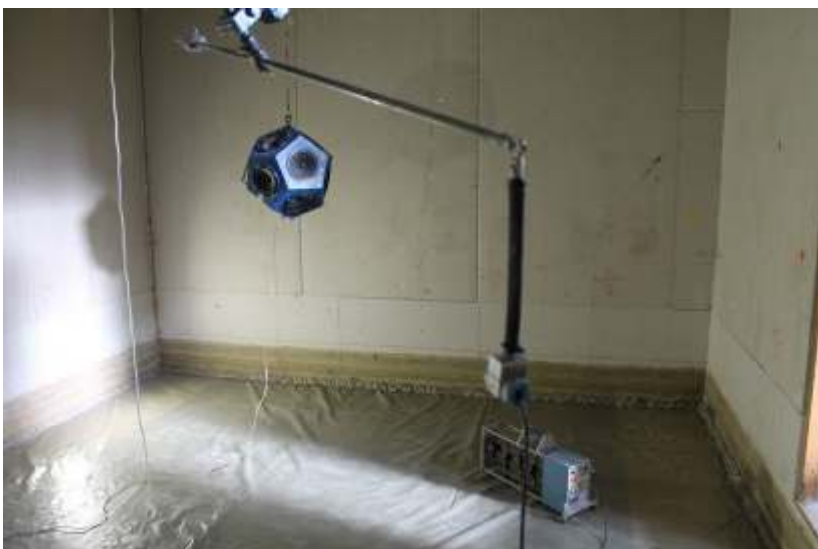
Prüfraum für Schallmessungen an Decken
