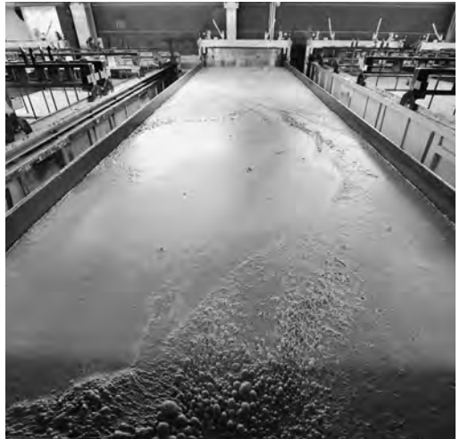
Fertig befüllte Gießform zu Beginn des Treibvorgangs.
