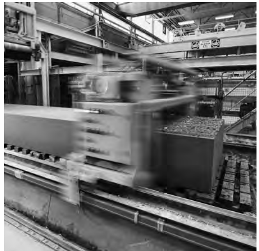
Schneiden und Profilieren der bis zu 8,30 m x 1,50 m x 0,75 m großen Blöcke.
