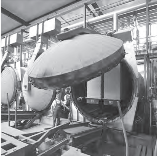
Aushärten in Autoklaven.
