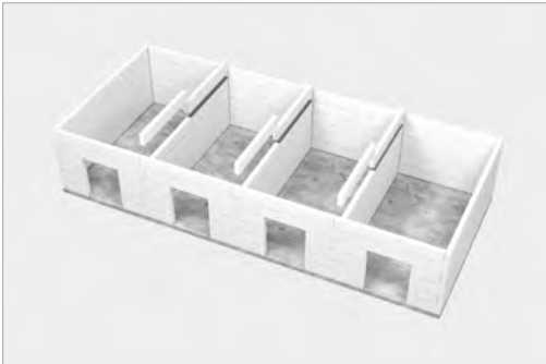
5. Vollständige Gebäudehülle im Bost-System
