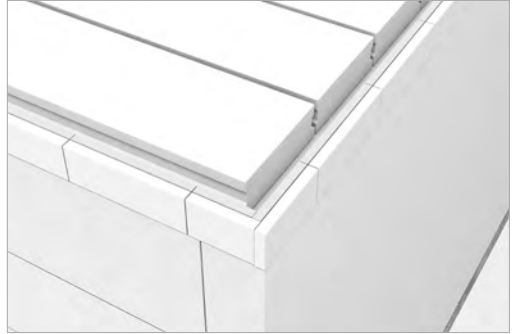
7. Dachausbildung mit Hebel Dachplatten
