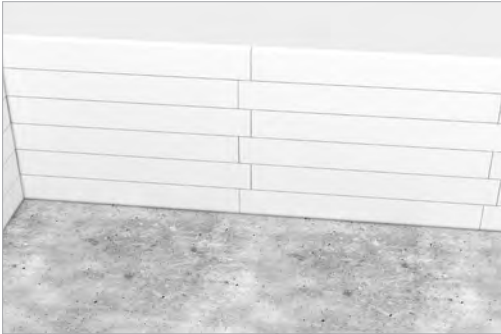
4. Montage mit Überbindemaß
