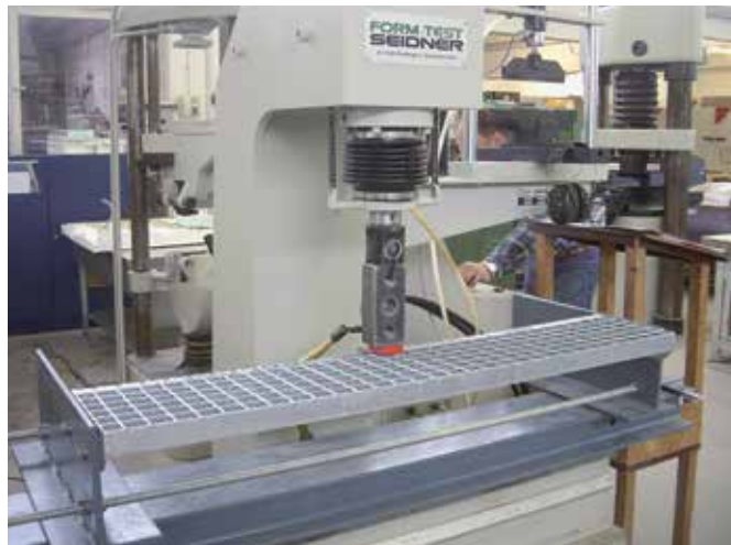
Bild 31: Prüfanordnung vor Lasteinleitung
