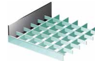
Bild 36: Fußleiste am Gitterrost
