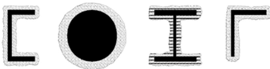
**Bild 1 — Bauteile mit Eisansatz**
